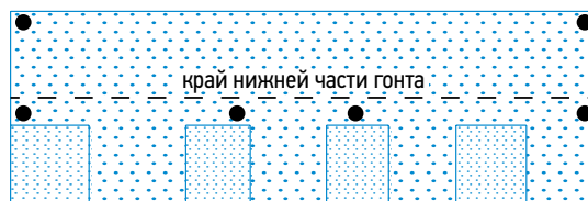
Уклон кровли более 60°
